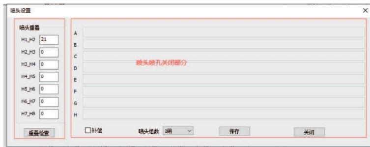
上图中包含两部分：1、喷头重叠。2、喷孔关闭（具体在工程师指导下操作）
