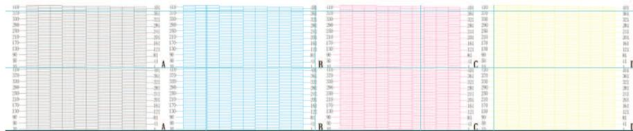
若发现测试条中有不连续或空缺地方，说明有堵塞，需要清洗，直到喷孔喷墨达到最佳状态
